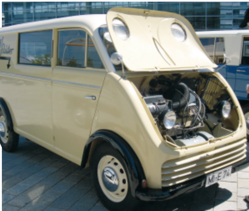
DKW Elektro Schnell- laster mit einem 5 kw Elek- tromotor der Firma Bädecker aus Bremen
